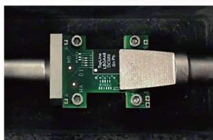
微电子芯片剪切测试
